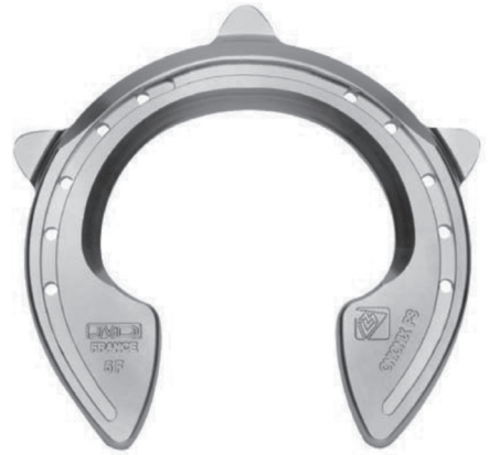
Şekil 19.89. Spor atlarında I. derece naviküler hastalıkta kullanılan ökçeleri geniş yüksek teknoloji alimunyum alaşımlı ön ayak nalı. Kalınlık 8 mm. (Anonim, 2019).
